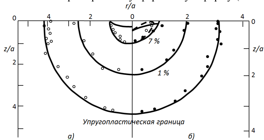
Рис. 2.1.2 Экспериментально определенные линии уровня пластической деформации при внедрении: а) шарового индентора (шарик Бринелля), \alpha/R = 0.51 ; б) пирамидального индентора, используемого для определения твердости по Виккерсу.
