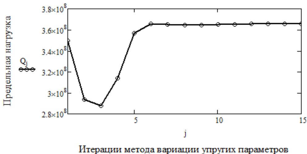
Рис. 5.2.2 Сходимость метода псевдоупругих параметров
