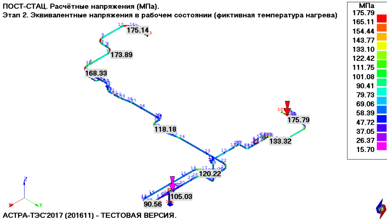
Рис. N4.4. Напряжения на этапе 2, МПа. Версия 201611
