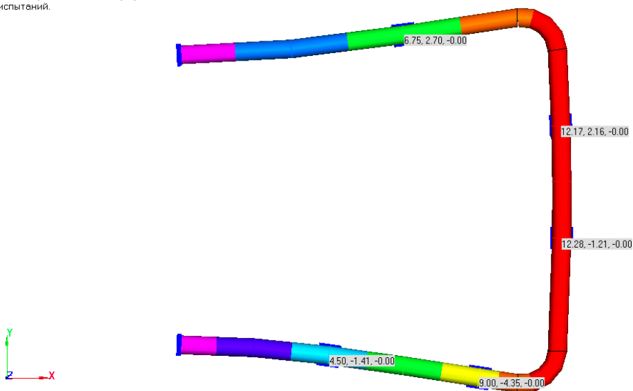
Рис. N1.1.10. Перемещения, м. Расчет без учета трения
