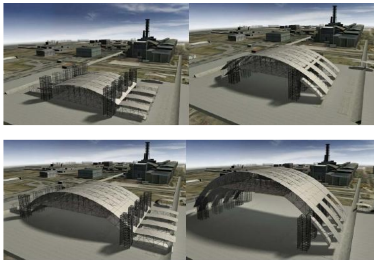
Схема монтажных операций (проект)
