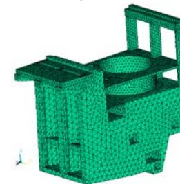
КЭ-модель агрегатного блока
