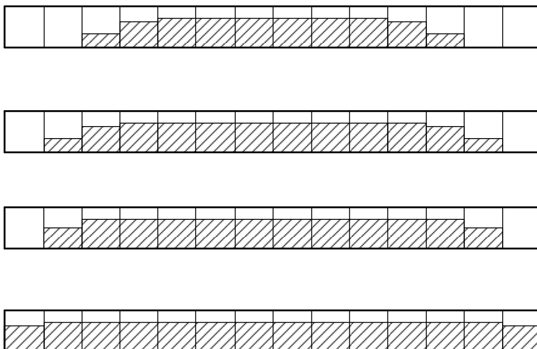
Рисунок П4.22 – Иллюстрация процесса развития повреждаемости в сечении плиты при величине нагрузки q 4/10, 6/10, 8/10, 1 от максимальной (в расчете)
