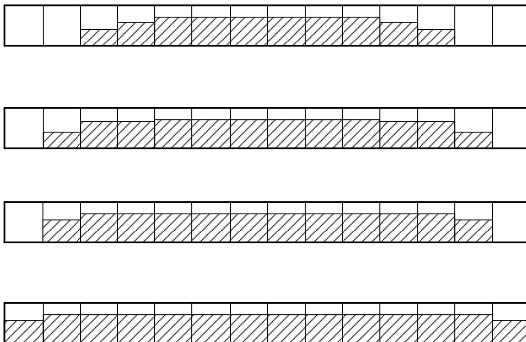
Рисунок П4.21 – Иллюстрация процесса развития повреждаемости в сечении плиты при величине нагрузки q 4/10, 6/10, 8/10, 1 от максимальной (в расчете)
