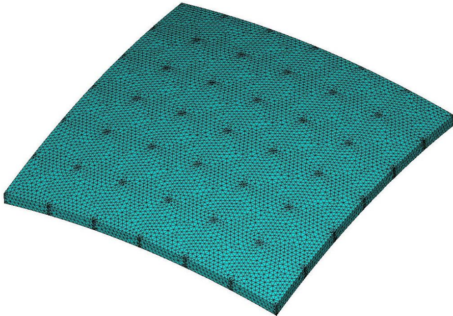
Рисунок 5.9 – Схема разбиения на КЭ оболочки № 1
