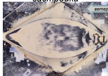
Физическое моделирование коэффициента \mu (НИУ МГСУ)
