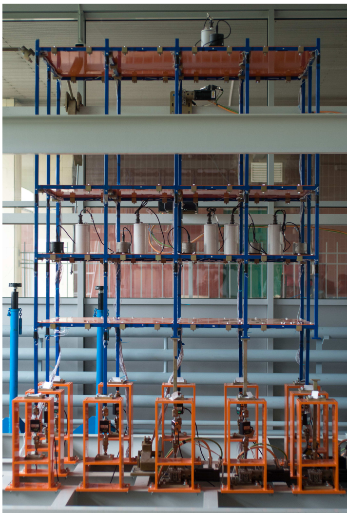
Рис.4.5 Расстановка измерительных датчиков на стенде «Этажерка», учет дефекта.
