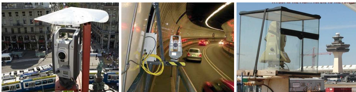
Рис.1.17 Примеры станций автоматического геодезического мониторинга.
