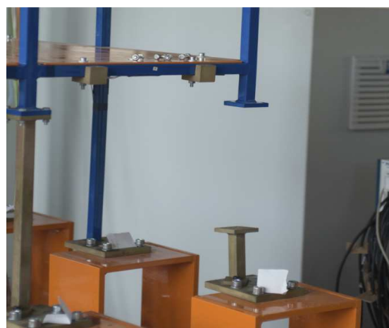
Рис.4.5 Расстановка измерительных датчиков на стенде «Этажерка», учет дефекта.
